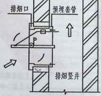
板式排烟口在竖井墙上安装
