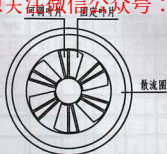
送风方向 45^{\circ} 时的叶片状态 (等温送风)
